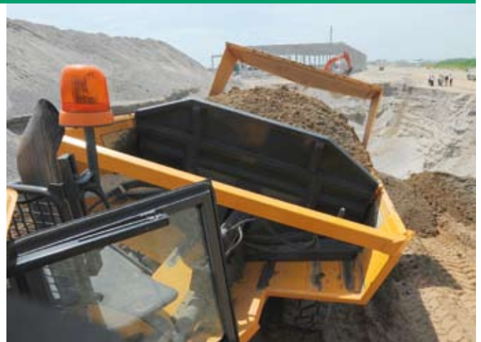
Volvo-Knickenker mit Fliegl „ASW Stone“, entlädt schräg stehend mit Abschiebesystem ASW Stone
